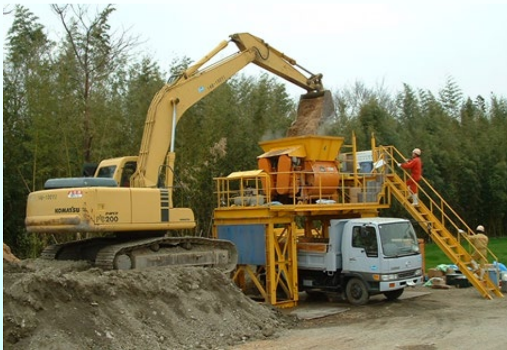
生育基盤材料の製造 定置式プラント 1.0 m 3
