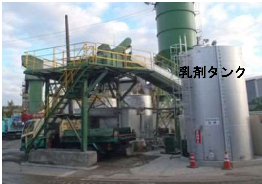
写真-5 CAE 専用製造プラント (最大製造能力 100t/h)
