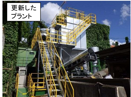
写真-3 異物除去プラント (風力選別式、大型連続式磁力選別機)
