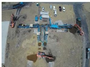
写真6 粘土・砂・礫の3種混合
