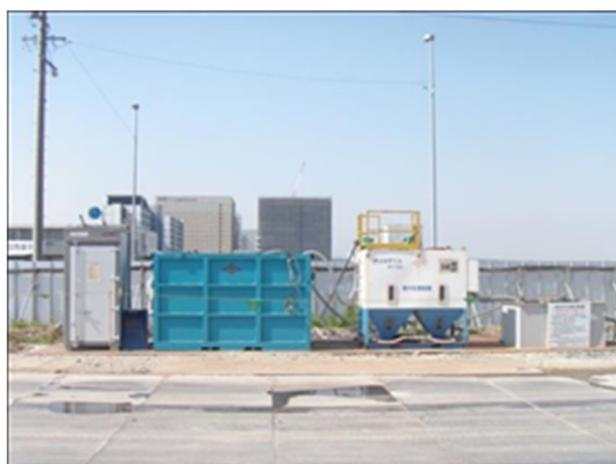
写真 12 排水浄化装置設置状況
