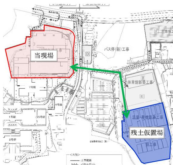
図-2 掘削土の場内仮置
