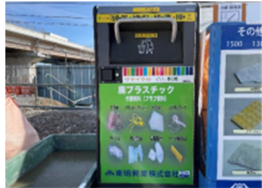
図6 自動圧縮機(スマゴ)の設置
